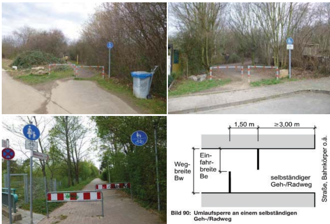
Abb. 58: Beispiele für Umlaufsperrn an Wegen mit Radverkehrsaufkommen sowie Gestaltungshinweis einer fahrradfreundlichen Umlaufsperrre
